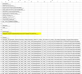
d. Probenblatt bcl2fastq (.csv), auf der linken Seite des Bildschirms, wird verwendet, wenn die Illumina bcl2fastq Software zur Demultiplexierung, Adaptertrimmung und Generierung der FASTQ-Datei eingesetzt wird.
